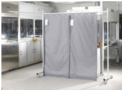
Die mehrlagige Laserschutzvorhangbahn BC6.F1P01.1251 mit (B x H) 900 x 2500 mm lässt sich über ein Ösenband an der Oberseite aufhängen. Zur Verbindung mehrerer Bahnen ist ein spezielles Silikon Pfeil- und Rillenband aufgenäht. Der Vorhang ist zertifiziert nach EN 60825-4 und geprüft nach EN 12254.
