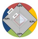
Transmission der Signalfarben nach DIN EN 172 // transmission of signal colours acc. to EN 172
