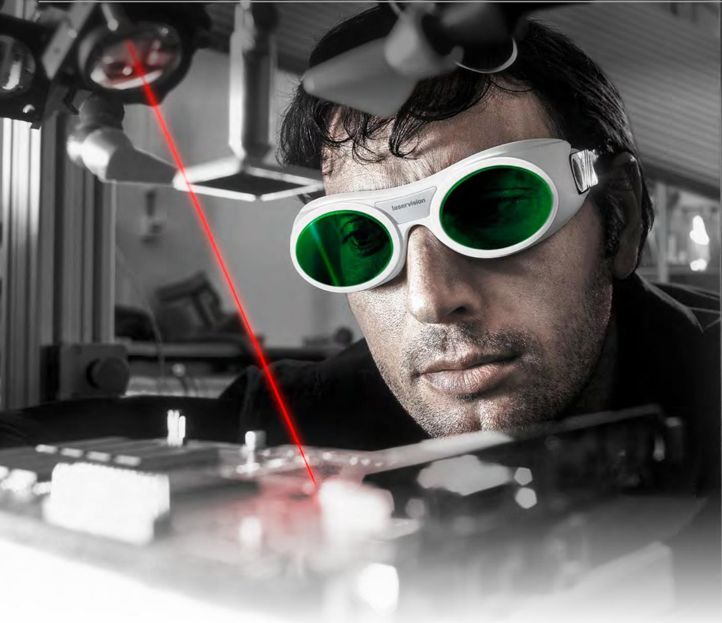
Im Geltungsbereich der Europäischen Laserschutznormen EN 207 und EN 208 muss eine Laserschutzbrille eine Reihe an Anforderungen erfüllen. Die wichtigsten beiden Funktionen sind die Laserfestigkeit und das Abschwächen der Laserstrahlung.
